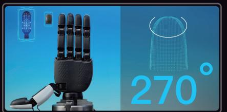
·每个手指配备一个270°指端环绕高分辨率(>100点)触觉阵列传感器，精度可达0.05 N，提供三维力触觉和温度信息，抓握性能强于压阻类平板型触觉传感器
