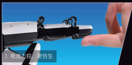
·力控比位控更仿生，能更精细地抓握柔韧性易碎物品，容错率高，结合触觉传感后，能进行更复杂的精细化灵巧操作
