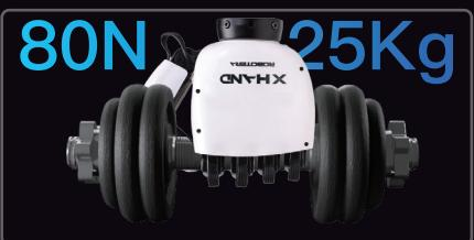
·最大负载25 Kg，最大握力80 N，远超同尺寸连杆和绳驱方案
