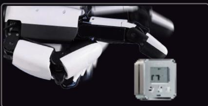
·全直驱方案，通过齿轮直接驱动，速度快于连杆和绳驱方案
