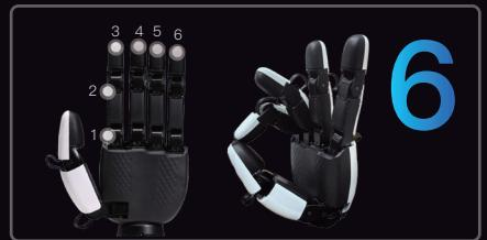
·操作范围大，拇指具备对指能力，Kapandji test中拇指可和图中1-6、6个位置对指
